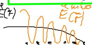
Definiere das makroskop. elektrostat. Feld in der Probe durch  $E(r) = \frac{1}{V} \int d\tau' E^{\text{mikro}}(r')$
