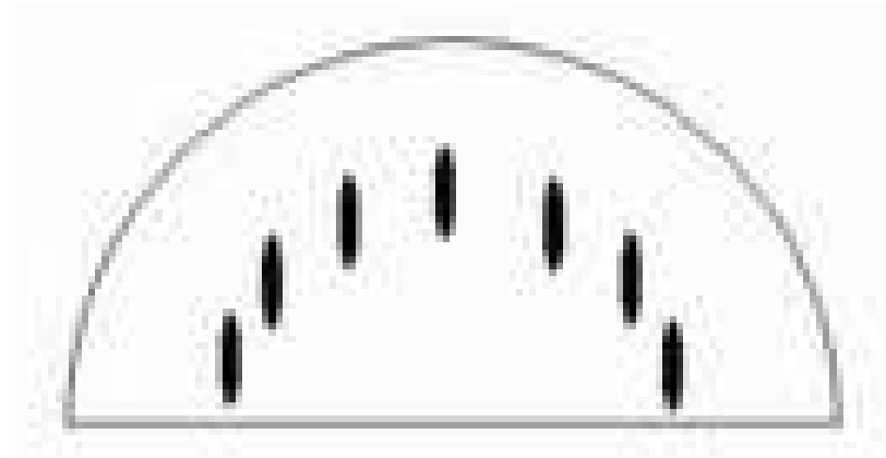
RHEED-Bild einer wahren, glatten Oberfläche
