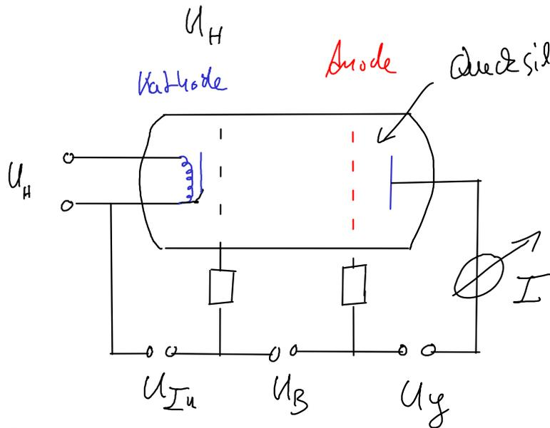
$U_{In}$ : Zur Regelung der Intensität der Strahlung
